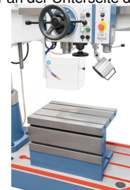
Drehrichtungsänderung bzw. Ein- und Auskuppeln der Spindel erfolgt mittels Pilotschalter an der Unterseite des Bohrkopfes
