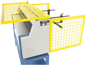
Aufklappbare Schutzabdeckung für eine leichte Entnahme des fertigen Werkstückes.
