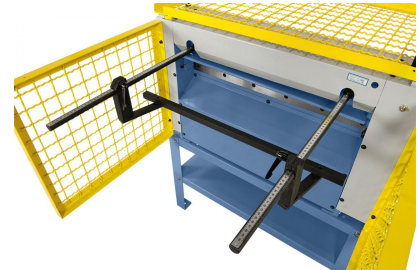
Von 0 - 500 mm einstellbare Hinteranschlag, ideal für Serienarbeiten.
