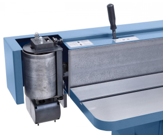
Oszillierendes Schleifaggregat mit 10 mm Hub.
