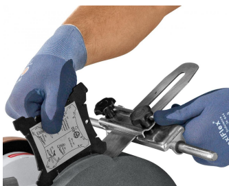
Einfaches Einstellen des optimalen Winkels mit der Winkellehre WL-60 (Standard).
