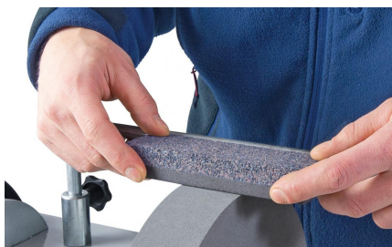
05-2050 Schleifstein: Dient zum Präparieren der Schleifscheibe (fein/grob)
