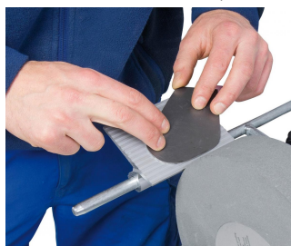
05-2056 Auflagetisch: Optimal zum Schleifen diverser Kleinteile
