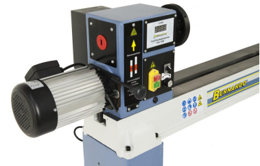
Der leistungsstarke Antriebsmotor gewährleistet auch bei niedrigen Drehzahlen ein hohes Drehmoment.
