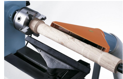
Die optional erhältliche Absaugung sorgt für einen sauberen Arbeitsplatz beim Dreheln.
