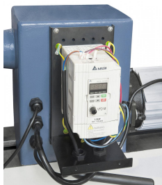
Variable Drehzahleinstellung durch Delta-Frequenzumrichter mit optimiertem Drehmomentverlauf
