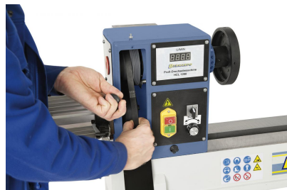
Einfaches Wechseln der Übersetzungsstufe durch Umlegen des Keilriemens.
