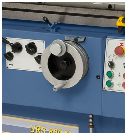
Handrad mit Skala (0,005 mm) für die manuelle Schleifspindelstockquerbewegung
