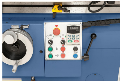
Übersichtlich und ergonomisch angebrachtes Elektro-Bedienpult
