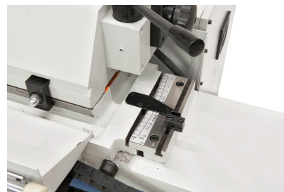
Zum Konischschleifen zwischen den Spitzen kann der Tisch von +3° bis -7° geschwenkt werden.
