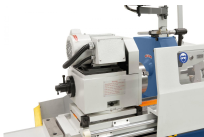
Schwenkbarer Spindelkopf von 0° - 90° zum Konischschleifen verstellbar.
