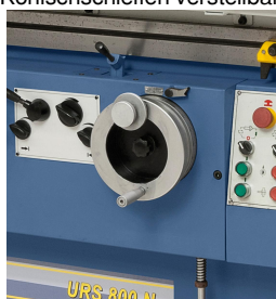
Handrad mit Skala (0,005 mm) für die manuelle Schleifspindelstockquerbewegung
