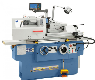
Serienmäßig mit Innenschleifeinrichtung
