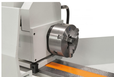
Der robuste Spindelkopf kann zum Konischschleifen bis max. 90° geschwenkt werden.
