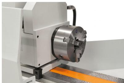
Der robuste Spindelkopf kann zum Konischschleifen bis max.  $90^\circ$  geschwenkt werden.
