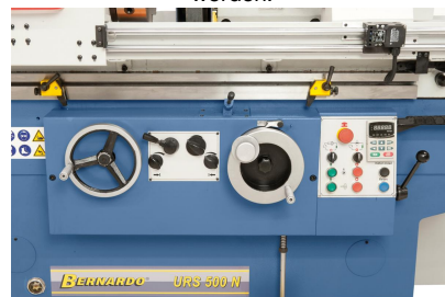
Die wichtigsten Bedienelemente sind übersichtlich an der Vorderseite der Maschine angeordnet
