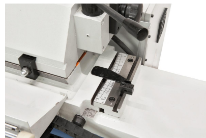
Zum Konischschleifen zwischen den Spitzen kann der Tisch von +3° bis -9° geschwenkt werden.
