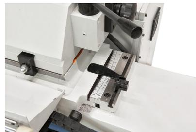
Zum Konischschleifen zwischen den Spitzen kann der Tisch von  $+3^\circ$  bis  $-9^\circ$  geschwenkt werden.
