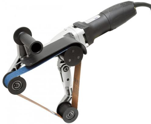
Die Rohrschleifmaschine TBS 760 ist ein besonders handliches und flexibel einsetzbares Gerät für diverse Schleif-, Polier- und Satinierarbeiten. Anwendung findet diese Maschine vorwiegend im Metall- und Geländerbau, sowie in Schlossereien.
