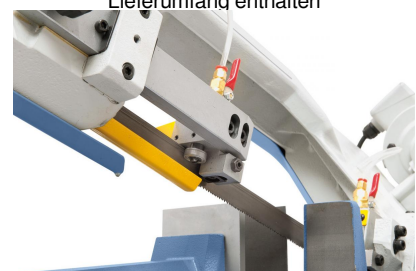
Kombinierte Rollen-Hartmetalleinsätze sorgen für eine ideale Sägebandführung und
