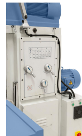
Logisch und übersichtlich aufgebaute Getriebeschaltung für die Horizontalspindel.
