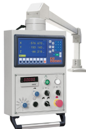
Variable Drehzahleinstellung der Vertikalspindel mittels Frequenz-umrichter.
