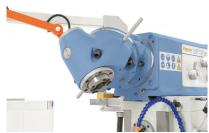
Universalfräskopf mit 2 Drehachsen, einstellbar auf sämtliche Winkelpositionen.
