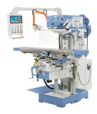
Die Universalfräsmaschine UWF 130 Servo mit verschiebbarem Oberarm ist eine Weiterentwicklung der bekannten UWF 130. Durch den auf sämtliche Winkelpositionen einstellbaren Fräskopf und einem Verfahrweg von 1000 mm in der x-Achse ist diese Maschine vielseitig einsetzbar. Besonderes Merkmal dieses Models ist der Eilgang und die 8 Vorschübe in allen Achsen, angetrieben über einen Servomotor.
