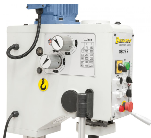
Einfache Bedienung der Schaltelemente für den Drehzahlwechsel.
