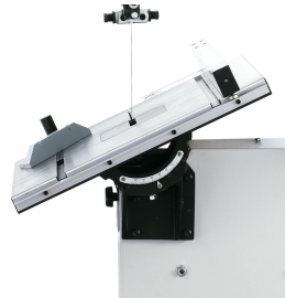
Der Arbeitstisch ist von 0° auf 45° schwenkbar, gewünschte Einstellung mittels Skala ablesbar
