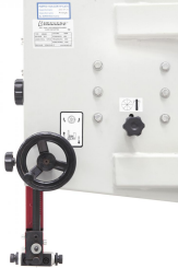
Ergonomisch angebrachte Handräder zur Einstellung der Blattspannung bzw. Schnitthöhe an der Rückseite der Maschine
