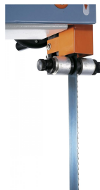
Optimale Führung des Sägebandes durch die wartungsfreie Präzisionsrollenführung
