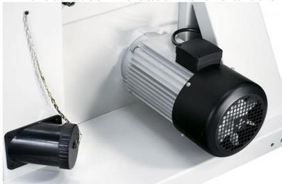
Durchzugsstarker Antriebsmotor mit Bremsfunktion, optimale Späneabfuhr durch den Absaugstutzen diam. 100 mm.
