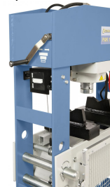
Serienmäßig mit Kurbel zum Verstellen des Zylinders (links / rechts) bzw. zur Höhenverstellung des Auflagetisches.
