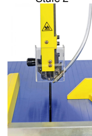
Inklusive Ausblasvorrichtung für optimale Sicht auf die Schnittlinie
