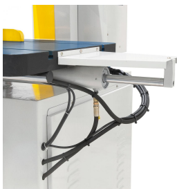
Hydraulikzylinder für Tischvorschub
