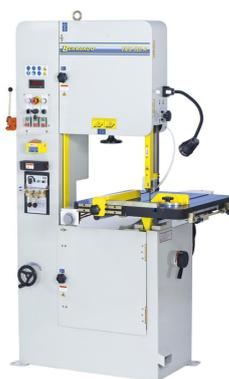
Die Vertikalbandsäge VMS 520 A ist mit einem automatischen Tischvorschub ausgestattet. Dieses Modell eignet sich zum Sägen von nahezu allen sägbaren Materialien (zB. Stahl, Kunststoff, NE-Metalle, Buntmetalle, ...). Ihren Einsatzbereich finden sie vorwiegend in der allgemeinen Produktion, im Werkzeug- und Vorrichtungsbau, bei der Herstellung von Stanz- und Schnittwerkzeugen.
