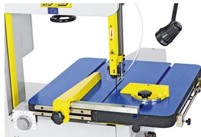
Längsanschlag für Geradeschnitte und Gehrungsanschlag für Winkelschnitte serienmäßig
