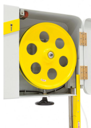
Die dynamisch ausgewuchteten Antriebsräder aus Grauguss sorgen für einen ruhigen Lauf der Maschine.
