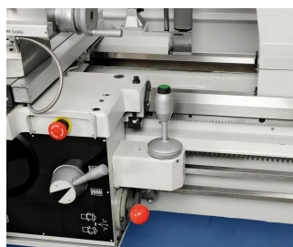
Serienmäßig mit Eilgang zur Reduzierung der Nebenzeiten
