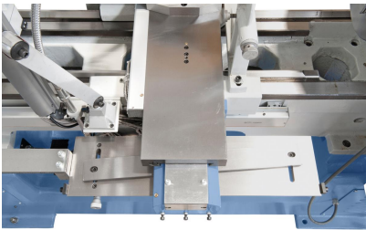
Kegeldreheinrichtung optional erhältlich, Drehlänge 405 mm, Einstellwinkel \pm 8^\circ
