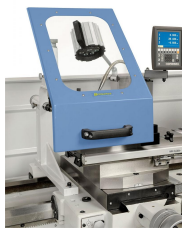
Der Schnellwechselstahlhalter ermöglicht eine Reduzierung der Nebenzeiten und gewährleistet eine hohe Wiederholgenauigkeit
