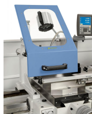
Der Schnellwechselstahlhalter ermöglicht eine Reduzierung der Nebenzeiten und gewährleistet eine hohe Wiederholgenauigkeit
