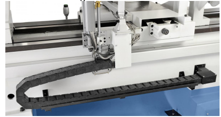
Inklusive Kabelführung über Energiekette
