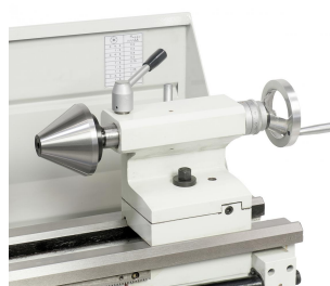
Der Reitstock mit Einhebelklemmung kann zum Kegeldrehen verstellt werden, auf Wunsch mit Zentrierkegel lieferbar
