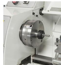
Das Spannzangenfutter ER 25 gewährleistet eine hohe Rundlaufgenauigkeit beim Spannen von Werkstücken, Spannungsbereich 1 - 16 mm.
