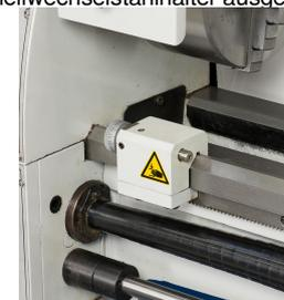
Serienmäßig mit Rutschkupplung und Mikrometerlängsanschlag ausgestattet
