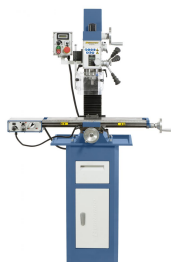
Serienmäßig mit digitaler Drehzahlanzeige und Rechts- Linkslaufeinrichtung
