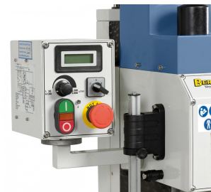
Serienmäßig mit digitaler Drehzahlanzeige und Rechts- Linkslaufeinrichtung
