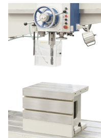
Präzisionsgelagerte Spindel für exakte Arbeitsergebnisse, Würfeltisch und Kühlmittleinrichtung im Lieferumfang enthalten.
