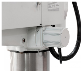
Serienmäßiger Hydraulikmotor für die Klemmung des Auslegerarms und des Bohrkopfes
