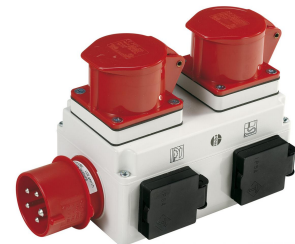
Einschaltautomatik ALV 10: Beim Ein- bzw. Ausschalten der Holzbearbeitungsmaschine wird die Absauganlage mit Zeitverzögerung zu- bzw. abgeschaltet (Option).
