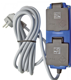
Einschaltautomatik ALV 2 / M 230 - 230V: Beim Ein- bzw. Ausschalten der Holzbearbeitungsmaschine wird die Absauganlage mit Zeitverzögerung zu- bzw. abgeschaltet (Option)
