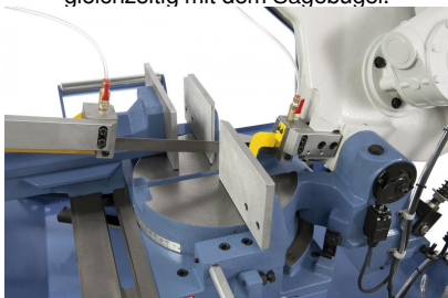
Der Sägeschlitz im Drehteller bewegt sich gleichzeitig mit dem Sägebügel.
