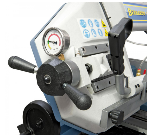
Das serienmäßige Manometer ermöglicht ein optimales Einstellen der Sägebandspannung.
