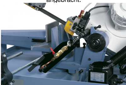
Für feinfühliges Absenken des Sägebügels serienmäßig mit Hydraulikzylinder ausgestattet.
