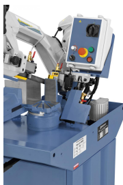
Schaltelemente übersichtlich im Elektropaneel angebracht.
