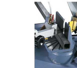
Der Sägebügel kann für Gehrungsschnitte von 90° bis 60° verstellt werden.
