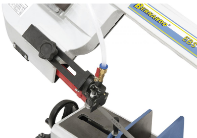
Kugelgelagerte Sägebandführung, einstellbar auf die jeweilige Werkstückbreite und Kühlmittelanschluss
