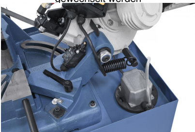
Kühlmiteleinrichtung im Lieferumfang enthalten.
