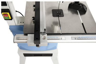
Der Längsanschlag ermöglicht durch die integrierte Lupe ein exaktes Ablesen der eingestellten Schnittbreite
