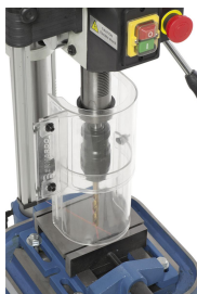
Präzises Arbeiten durch die serienmäßige Kreuzlinien- Lasereinrichtung
