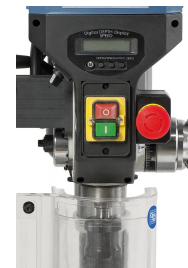
EIN-AUS Schalter nach IP 54 und separater Not-Halt-Taster nach CE-Norm
