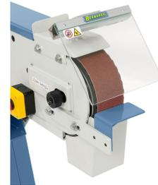
Werkstückauflage und Späneauffangbehälter im Lieferumfang enthalten
