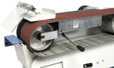
Großdimensionierte Kontaktscheibe und automatische Bandspannung
