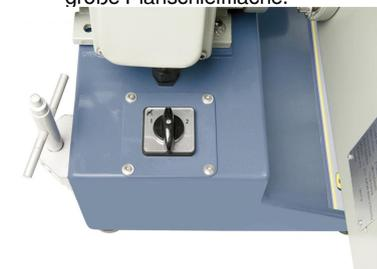
Serienmäßig mit 2-Stufenschalter für 2 Geschwindigkeiten, optimal zum Schleifen von Edelstahl und Aluminium
