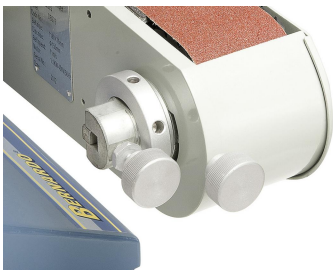
Einfaches Einstellen des parallelen Bandlaufs mittels Einstellschrauben
