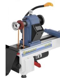
Die Kraftübertragung auf die Pinole erfolgt über einen robusten Riemenantrieb
