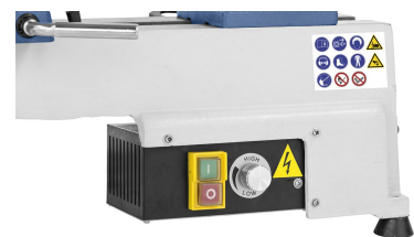
Optimale Anpassung der Drehzahl durch die stufenlose Regelung
