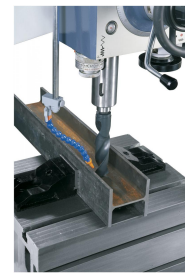
Präzisionsgelagerte Spindel für exakte Arbeitsergebnisse, Würfeltisch und Kühlmittleinrichtung im Lieferumfang enthalten.
