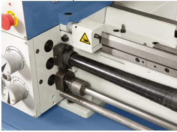
Mikrometerlängsansschlag und Rutschkupplung im Lieferumfang enthalten
