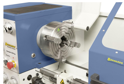
Planscheibe 200 mm (Standard), ideal zum Spannen von asymmetrischen Werkstücken
