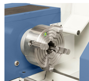
Planscheibe 200 mm (Standard), ideal zum Spannen von asymmetrischen Werkstücken
