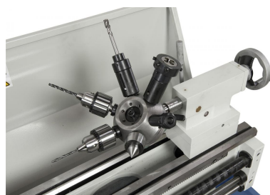
Optional lieferbar: Revolverkopf mit 6
