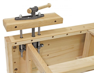
Französische Vorderzange mit Stahlspindel und Parallelstabführung
