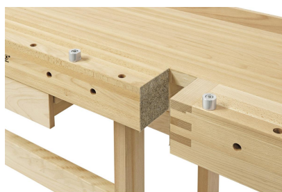
Hinterzange mit Filzauflage zum Schutz empfindlicher Werkstücke
