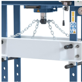
Inklusive Vorrichtung zur Höhenverstellung des Arbeitstisches.
