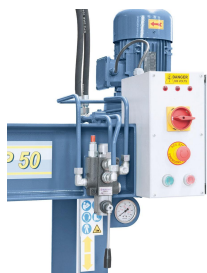
Ein feinfühliges Zustellen und Stoppen des Kolbens wird mittels Spezialhebel gewährleistet.
